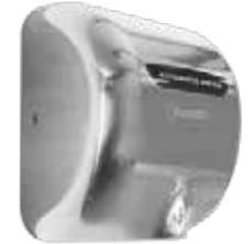
Dispensador de aire, con sistema de sensor para uso de manos libres. Carcasa del secador elaborado por conformado de embutición en lámina de acero inoxidable. Chasis elaborado en plástico inyectado. Voltaje 110V, frecuencia 50/60HZ, potencia 1800 W, Velocidad del aire 90m/s, velocidad máxima del motor 25000 RPM, corriente de aire 320 Km/h. aire caliente.
